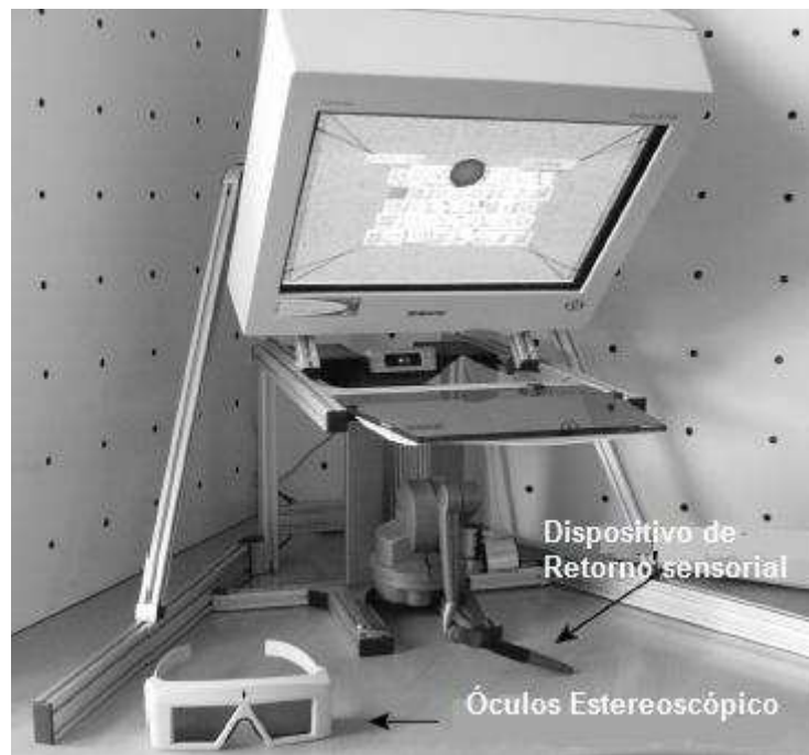
Figura 22 - Dispositivos utilizados pelo sistema de RV semi-imersivo
